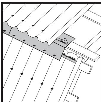
Внешний излом кровли можно оформить при помощи **щипцовых** либо **коньковых элементов ОНДУЛИН**. Нахлест элементов составляет 10-15 см. Для закрытия просветов и обеспечения вентиляции используется **заполнитель коньков и карнизов**.
