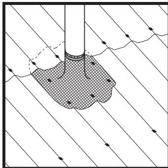
Проход вентиляционного канала/вытяжки через кровлю можно загерметизировать при помощи лент **ОНДУФЛЕШ-СУПЕР** либо проходного элемента «Мастер-флеш» или подобного. Верх примыкания ленты к трубе рекомендуется затянуть металлическим хомутом. Верхняя часть ленты на кровле должна заходить под верхний лист либо коньковый элемент.
