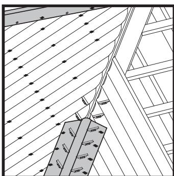
На ребрах кровли прибивать коньковый элемент нужно по каждой волне нижележащего листа к дополнительным брускам обрешетки. Для закрытия просветов и обеспечения вентиляции используется **заполнитель коньков и карнизов**.
