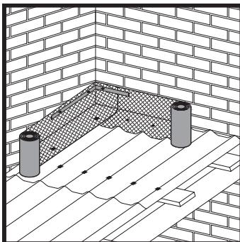
Торцевой и боковой стык кровли со стеной/трубой изолируется лентой ОНДУФЛЕШ-СУПЕР. Нахлест ленты на стене **150 мм**. Верх ленты прижимается к стене металлической планкой. Низ ленты прижимается и дополнительно крепится гвоздями в верх волны нижележащего листа. Лента раскатывается снизу вверх. Минимальный нахлест одного полотна ленты на другой **100 мм**. Также при оформлении **бокового стыка кровли со стеной** возможно использование **ендовы ОНДУЛИН**.
