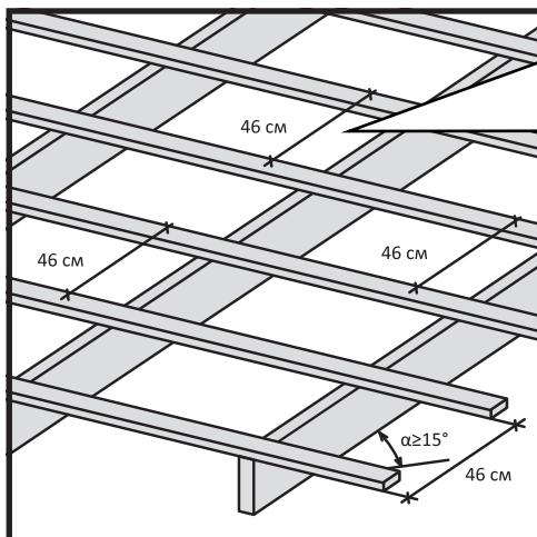
При угле наклона крыши от 15° (уклон от 1/4) делается **обрешетка из доски или бруса** с интервалом **46 см**.
