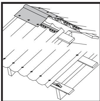
Заполнитель для Черепицы ОНДУЛИН используется для закрытия просветов листов на карнизе, между коньковым элементом и кровельными листами, а также в местах примыкания кровли к стене, ендовах и ребрах. Способ применения заполнителя зависит от вентиляции каждой кровли.
