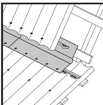
Внутренний излом кровли можно оформить при помощи **ендовы ОНДУЛИН**. Нахлест элементов составляет **15 см**. Для герметичности стыки проклеиваются двусторонней **битумной лентой**. Для закрытия просветов и обеспечения вентиляции используется **заполнитель коньков и карнизов**.
