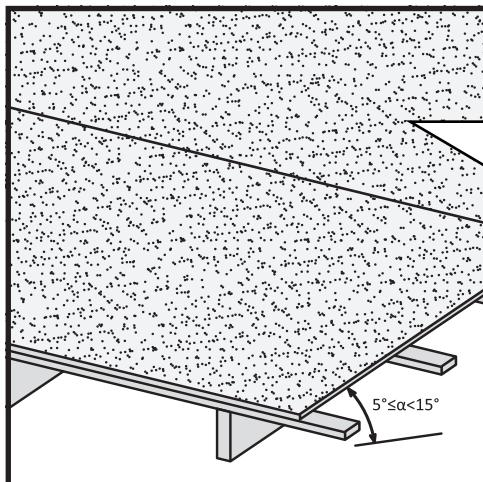
При угле наклона крыши 5-15° (уклон от 1/11 до 1/4) требуется **сплошная обрешетка** из доски, фанеры ФСФ, ОСП 3, ЦСП, фибролитовых плит и т.д.
