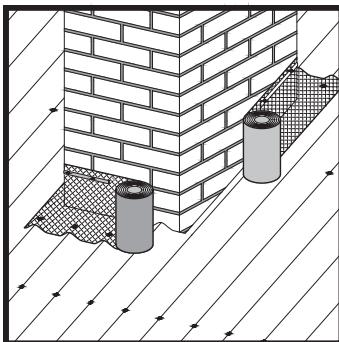
Примыкание кровли к трубе закрывается лентой ОНДУФЛЕШ-СУПЕР. Нахлест ленты на трубу **150 мм**. Верх ленты прижимается к стене металлической планкой. Низ ленты прижимается и дополнительно крепится гвоздями в верх волны нижележащего листа.
