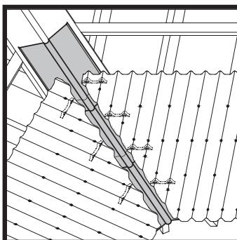
Для оформления ендов используйте специальные ендовы ОНДУЛИН. Для их крепления требуется дополнительная обрешетка. Нахлест элементов ендовы составляет **15 см**. Рекомендуется использование **подкладочной гидроизоляции и заполнителей** для защиты от протечек.
