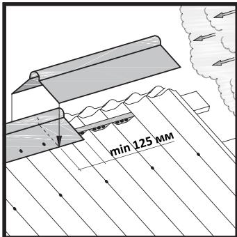
Для оформления коньков используются коньковые элементы для Черепицы ОНДУЛИН. Они крепятся к дополнительному брусу обрешетки с противоположной превалирующим ветрам стороны. Минимальным нахлест одного конька на другой 12,5 см. Коньки прибиваются по каждой волне нижележащего листа. Для закрытия просветов и обеспечения вентиляции используется **заполнитель коньков и карнизов**.
